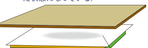
⑬ 片方を静かに持ち上げて、刷毛で空気を抜きながらパネル板面に吸い付かせる。
